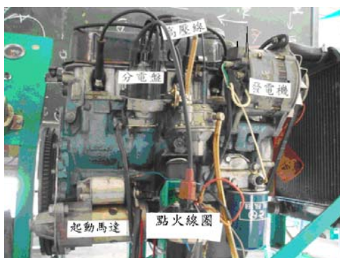
圖 3-4-36 連接點火線圈的主高壓線、低壓線及安裝真空提前橡皮管
