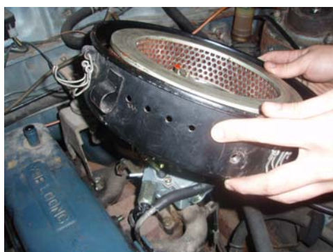
圖3-2-26 拆下空氣濾清器
