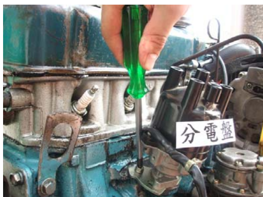
圖 3-4-29 拆下分電盤固定螺絲
