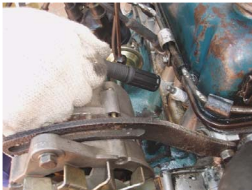
圖 3-4-23 火星塞處的高壓線接頭
