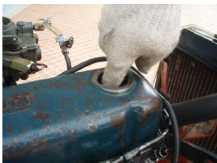
圖 3-4-32 確認第一缸位於壓縮上死前的位置
