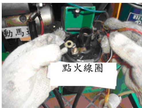
圖 3-4-27 拆開點火線圈的 (+)、(-) 線頭
