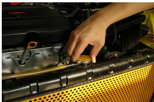
圖 3-3-12 打開水箱蓋檢視主水箱中冷卻液量
