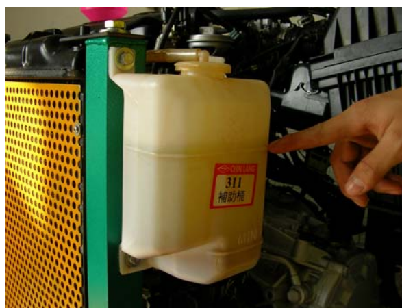
圖 3-3-11 檢視副水箱冷卻液的液面高度
