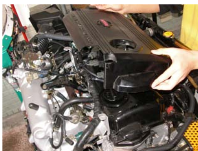
圖 3-3-16 拆下引擎上飾板
