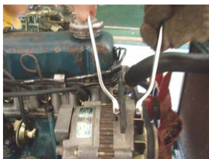
圖 3-4-17 拆開調整螺絲
