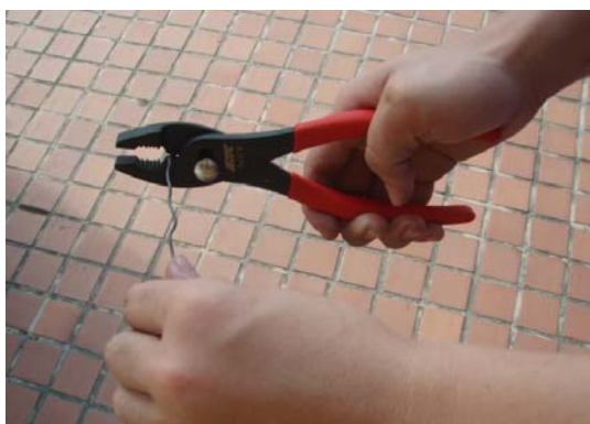
圖 3-1-26 鯉魚鉗剪斷鐵線
