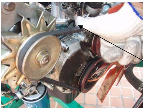
圖3-2-23 檢查皮帶緊度
