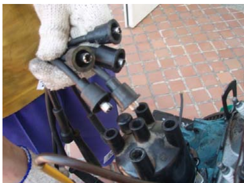
圖 3-4-25 拆離所有高壓線
