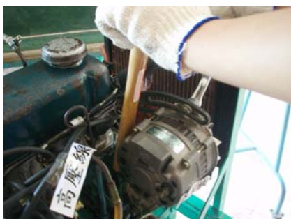
圖 3-4-21 調整皮帶的鬆緊度
