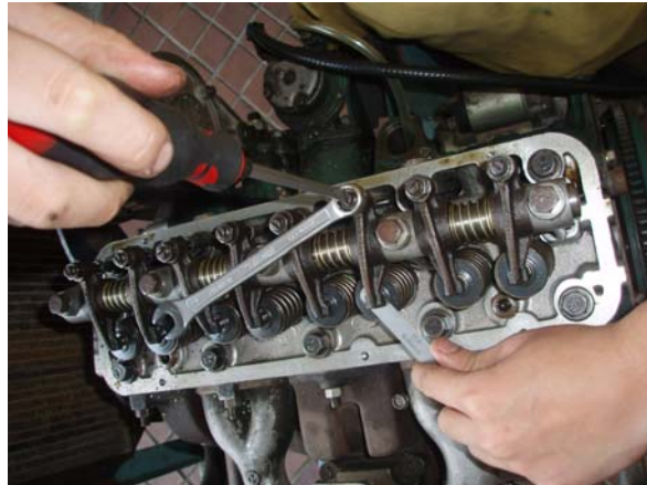
圖3-2-36調整汽門腳間隙
