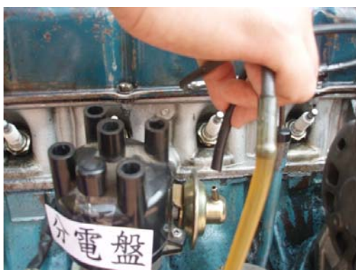
圖 3-4-26 拆開真空提前橡皮管
