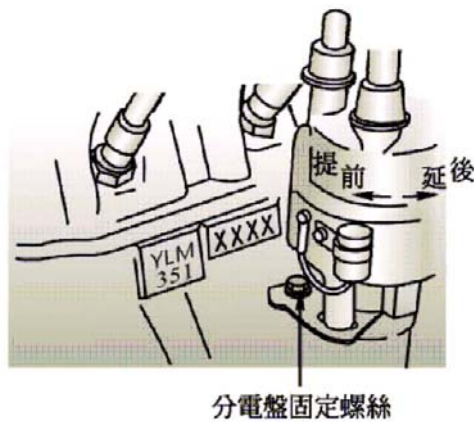
圖3-2-32 轉動分電盤外殼調整點火正時
