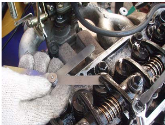
圖 3-1-28 厚薄規量汽門間隙
